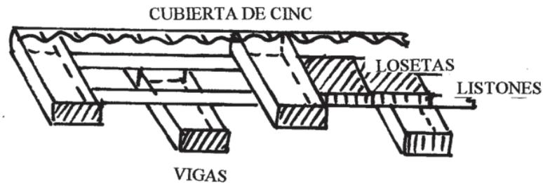
Fig. 5. Forma de armado del techo.
